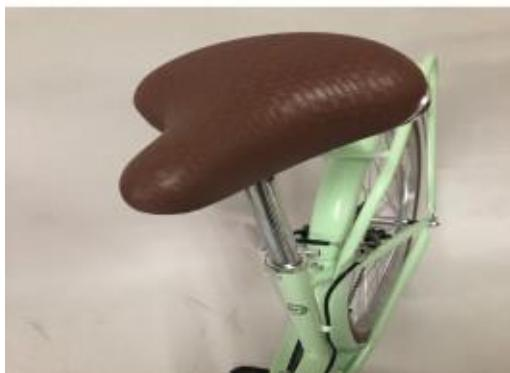
Insérez la tige de selle dans les ouvertures correspondantes et fixez-la à la hauteur souhaitée à l'aide du serrage rapide.
