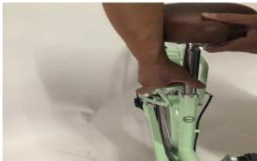
Fügen Sie die Sattelstange in entsprechende Öffnungen und fixieren Sie diese mittels Schnellspanner auf gewünschter Höhe.
