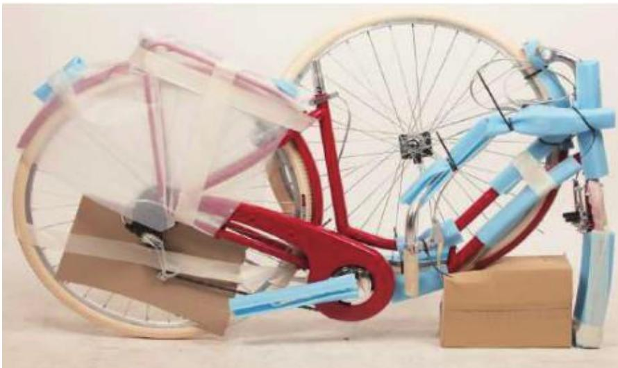
Packen Sie Lenker aus und installieren Sie diese in der Lenkerstangenbefestigung. Richten Sie den Lenker auf Ihre gewünschte Höhe aus und fixieren Sie mit dem Sechskantschlüssel. Sie können den Lenkerwinkel, sowie die Bremsen mittels Sechskantschlüssel einstellen.
