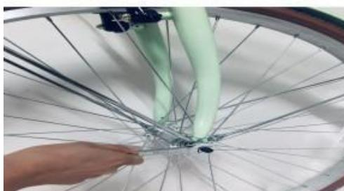
Placez l'axe de la roue dans les trous correspondants de la fourche, centrez la roue et serrez les écrous.
