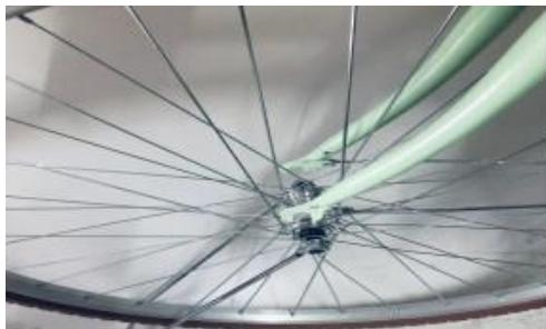
Setzen Sie die Radachse in die entsprechenden Öffnungen an der Gabel, zentrieren Sie das Rad und ziehen Sie die Muttern fest.
