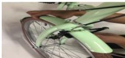
Ziehen Sie das vordere Schutzblech übers Vorderrad und befestigen Sie es bei den entsprechenden Punkten an der Gabel.
