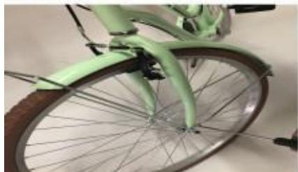
Tirez le garde-boue avant par-dessus la roue avant et fixez-le à la fourche aux points correspondants.
