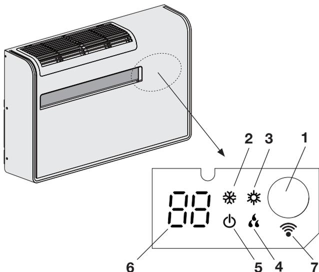
1. **Empfänger:** empfängt die von der Fernbedienung ausgesandten Signale.
